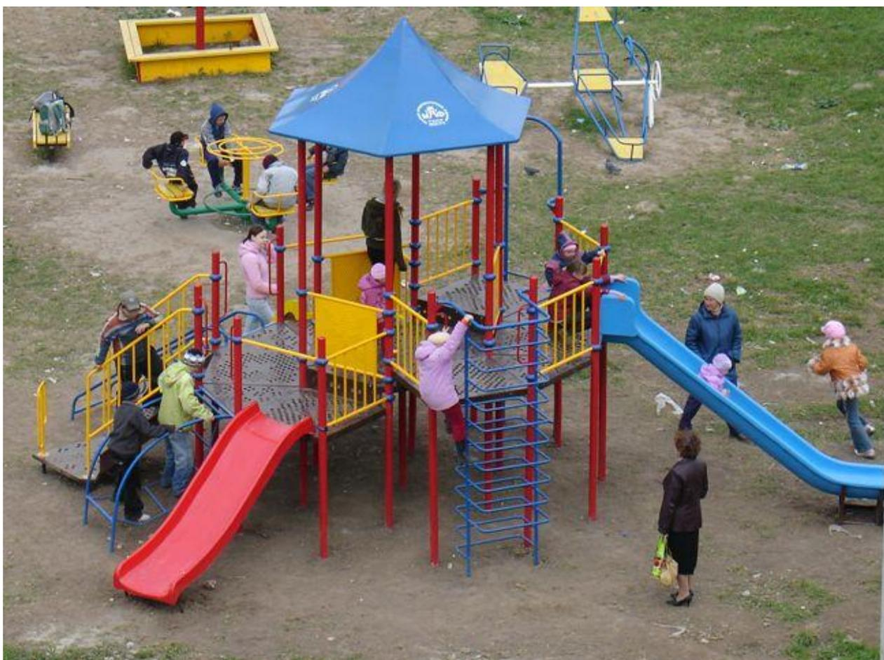
**Описание:** В комплексе 2 малые горки (высота ската 1000 мм, длина 2350 мм), одна большая горка (высота и длина ската 1500 и 3660 мм соответственно), несколько лазов и рукоходов. Ограждение и скат горки выполнены из стеклопластика. Опоры и площадки из металла. На ограждениях изображены зверюшки.
