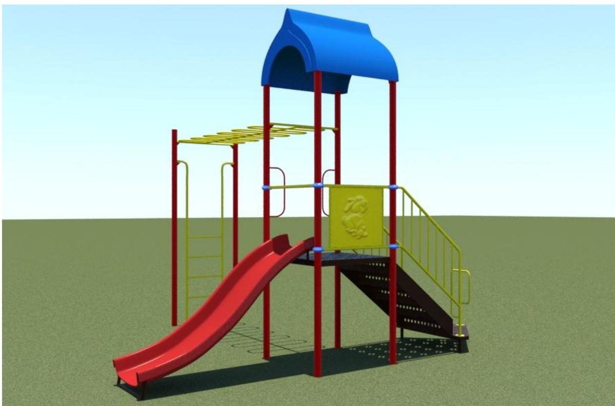
**Описание:** В комплексе - горка, лестница, крытая площадка с выходом на рукоход. Купол, скат горки и ограждение сделаны из стеклопластика. Длина ската горки - 2350 мм, высота ската - 1000 мм. В ограждении выбито изображение зверюшек.
