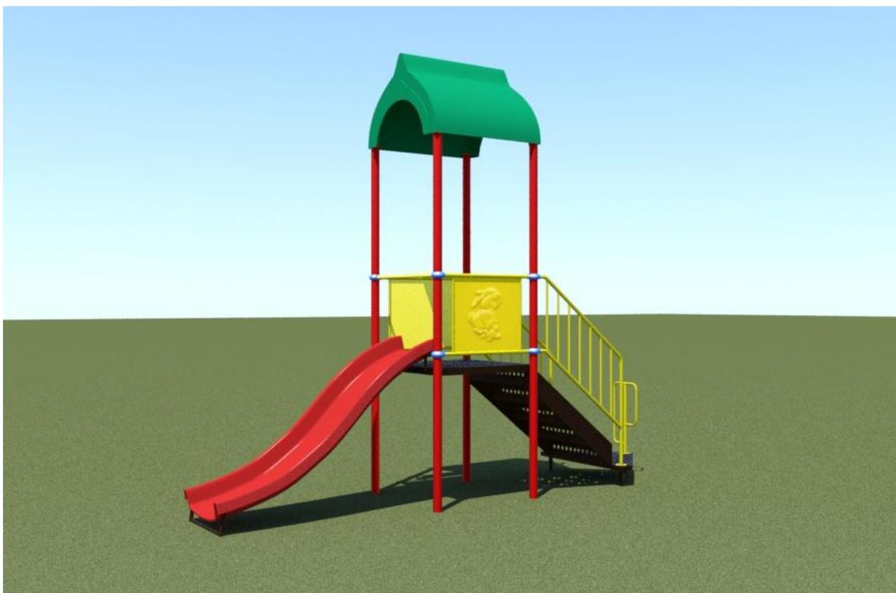
**Описание:** В состав комплекса входят горка, лестница и крытая площадка. Купол, ограждение и скат горки выполнены из стеклопластика. Длина ската горки - 2350 мм, высота ската - 1000 мм. Ограждение содержит изображение разных зверюшек.
