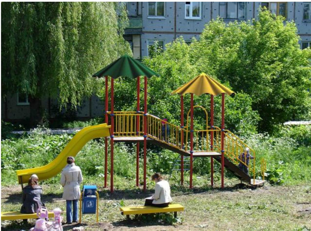
**Описание:** Состоит из горки, двух площадок на разных уровнях, лестницы и лаза. Крыша, лоток и ограждения из стеклопластика. Длина ската горки - 3660 мм, высота ската - 1500 мм. Ограждения площадок с изображением зверюшек.
