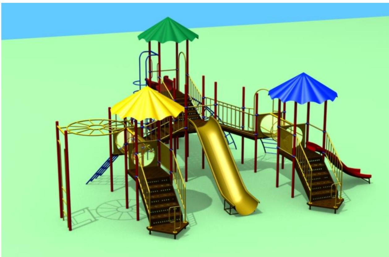
**Описание:** В игровом комплексе есть площадки, два лаза, рукоход, малая горка (высота ската 1000 мм, длина 2350 мм), большая горка (высота и длина ската 1500 и 3660 мм соответственно), винтовая горка (высота 2000 мм, диаметр 1550 мм). Купола, скаты горок и ограждения производятся из стеклопластика. Опоры, площадки и мостики изготовлены из металла. Имеются два лаза-тоннеля из поликарбоната. На ограждениях изображены зверюшки.
