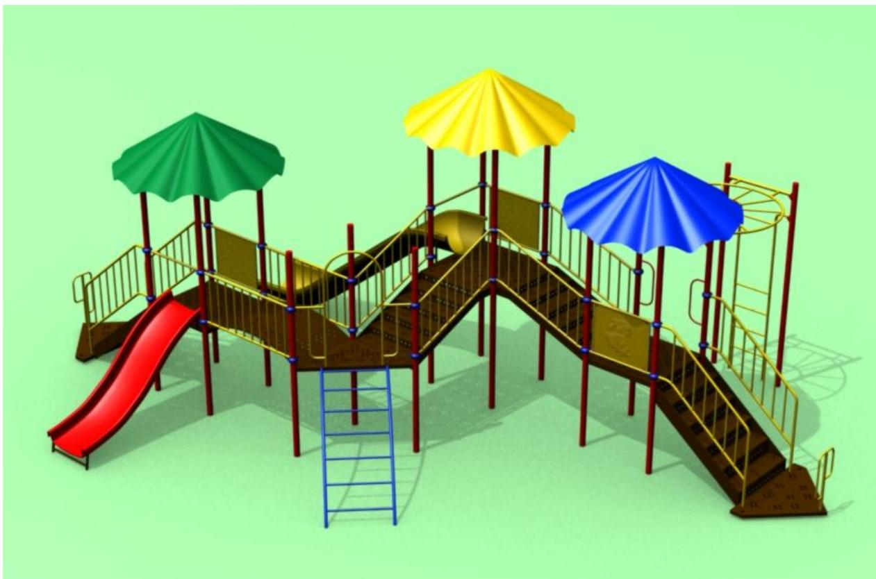
**Описание:** Комплекс состоит из двух горок разного уровня с высотами ската - 1000 и 1500 мм (длины скатов: 2350 и 3660 мм соответственно), лаза, рукохода. Стойки, площадки и мостики изготовлены из металла. Купола, скаты и ограждения выполнены из стеклопластика. На ограждениях изображения зверей.
